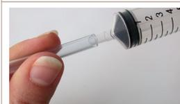
1. Insérer l'embout de sortie de la pipette graduée dans le tube jusqu'à ce que celui-ci l'entoure complètement sur une profondeur de 8 mm environ.
